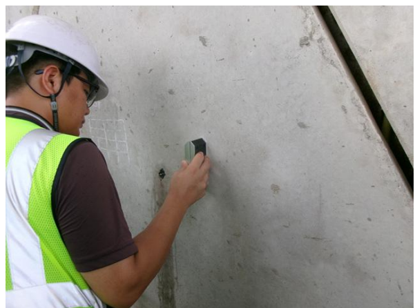
경사계를 이용한 경사도 측정
